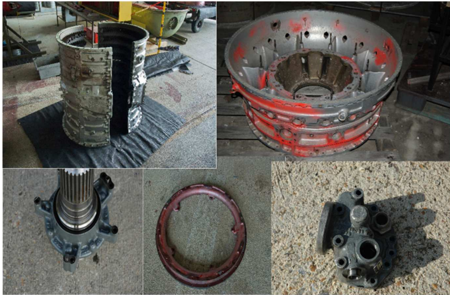
Figure 10 : pièces moteurs - éléments démontés constituant les déchets radioactifs [photos EAR 279]
