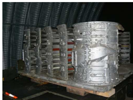
Figure 14 : ancien conditionnement en palette (18-demi-carters) à gauche et nouveau conditionnement en conteneur de 6 m 3 (27 demi-carters) à droite
