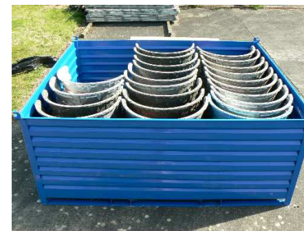
Figure 14 : ancien conditionnement en palette (18-demi-carters) à gauche et nouveau conditionnement en conteneur de 6 m 3 (27 demi-carters) à droite
